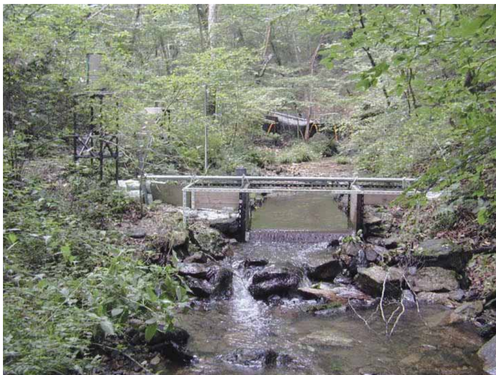
Photo 3. 小川群落保護林に設置した手製の量水堰 Handmade gauging weir built in the OFR
