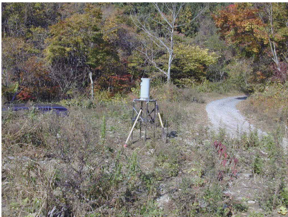
Photo 1. 主雨量計 Main rain gauge
