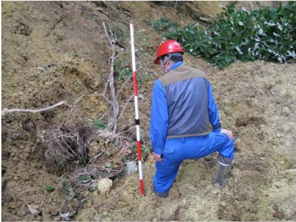
写真5 日影森地すべり（アースフロー）の流走域下端付近で認められた容易に液化化する土砂の様子。
