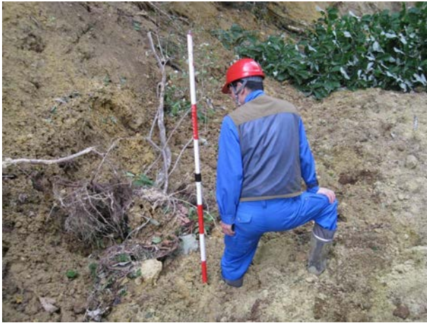
写真5 日影森地すべり（アースフロー）の流走域下端付近で認められた容易に液状化する土砂の様子。
