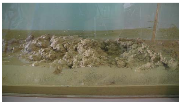
写真6 実験FE-Bにおいて水平水路上を運動し堆積したブロック状の土砂の様子
