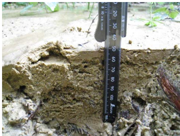
写真4 日影森地すべり (アースフロー) のすべり面より滲出した細粒土粒子の堆積層 (約 10mm の厚さと認められる) .
