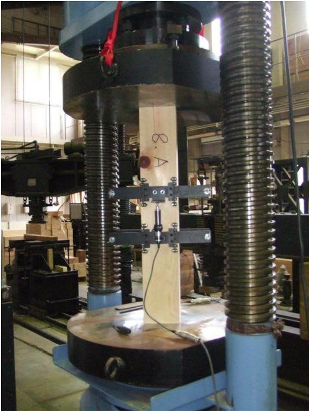
Photo 4. 正角の縦圧縮試験
