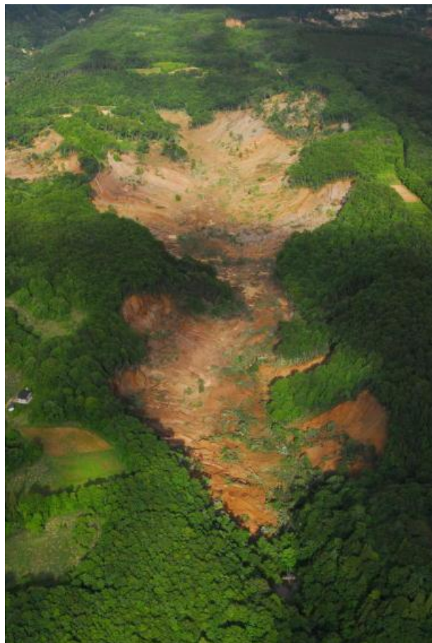
Photo 5. 耕英地区冷沢の荒廃状況 (朝日航洋 (株) 撮影)。上流 (写真下) から下流 (写真上) を撮影している。流域全体が流動化している様子がわかる。特に、写真上部 (下流側) では右岸上部の平坦地が溪流側 (斜面下) に側方に移動し、平坦部には樹木が残っている。Photo 7 はこの付近の地上で撮影している。Devastation of Hiyasawa valley in Koei area. The Photo was taken from the upstream by Aero Asahi Corporation. The whole valley of Hiyasawa fluidized by the earthquake. The spreading toward to the stream emerged at the upper part which is the downstream of Hiyasawa valley. Rotated trees remained on the flat ridge of right bank.
