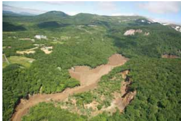
Photo 9. ドゾウ沢土石流により被災した駒の湯温泉（中央）と対岸の地すべり（中央手前）。対岸の地すべりが河道を閉塞したところに、右上からの土石流が旅館（中央の裸地）を直撃した。Komanoyu hot spring inn at the center of the photo was hit directly by the Dozouzawa debris flow shown in Photo 8. The landslide of the opposite bank clogged the stream, before the debris flowed from the right hand side.
