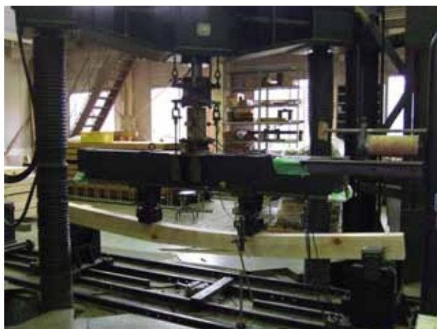
Photo 3. 平角の曲げ試験 Bending test of square lumber
