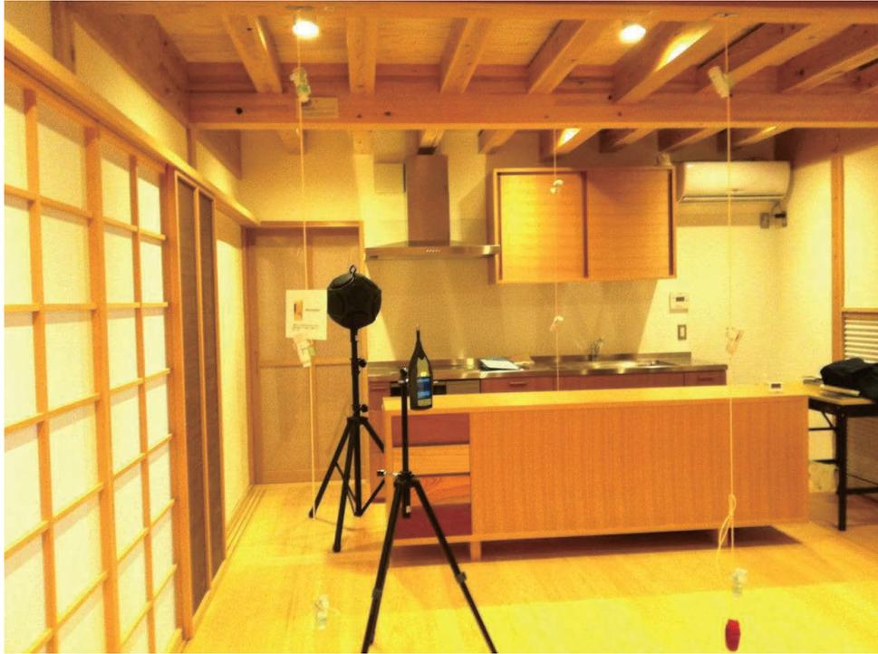
写真 1. 室間音圧レベル差測定のために 1 階の食堂居間に設置された無指向性スピーカーと騒音計
