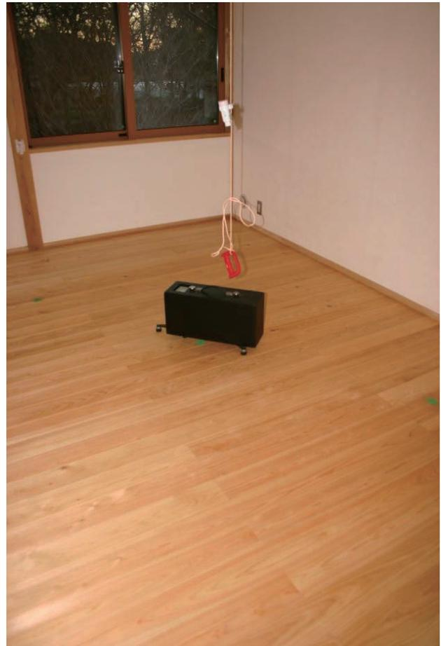
写真 3. タッピングマシン（軽量床衝撃源）
