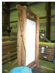
Photo 14. 土壁試験体
