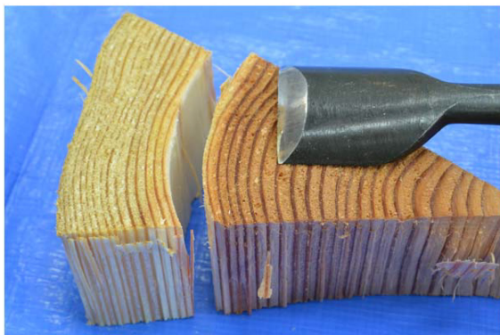
写真 4. 幹各部位の放射性 Cs 濃度測定用試料の調整の様子 (a) ミカン割り作業中のアカマツ円板 (b) ミカン割りしたスギ円板 (c) 辺心材に分割したスギ材試料と丸のみ (d) コナラ樹皮の切断作業
