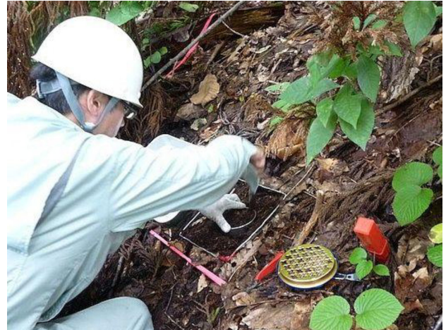
写真2. 採土円筒による土壌試料の採取 Photo 2. Sampling using a soil sampling cylinder
