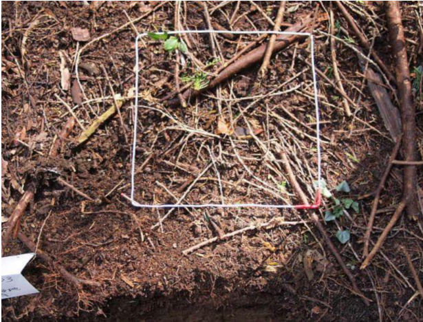
写真1. 堆積有機物試料採取用25×25cm 方形枠の固定状況 Photo 1. Fixing a 25 cm × 25 cm quadrat for litter sampling
