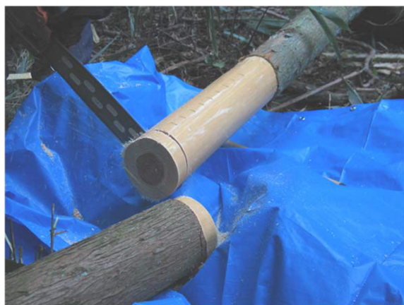
写真 3. 幹（木材）各部位の放射性 Cs 濃度測定用試料の採取の様子
