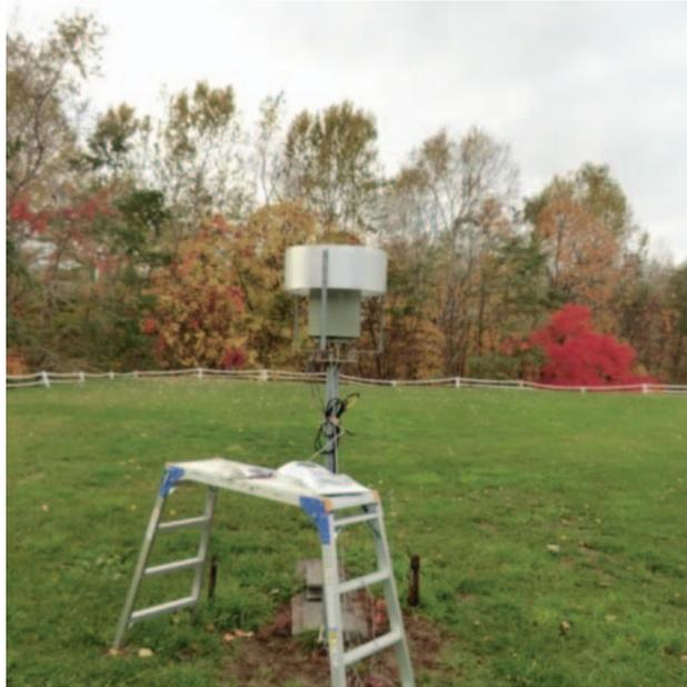
Photo 8. 溢水式雨量計 B-071-12 (横河電子機器) を用いた降水量観測
