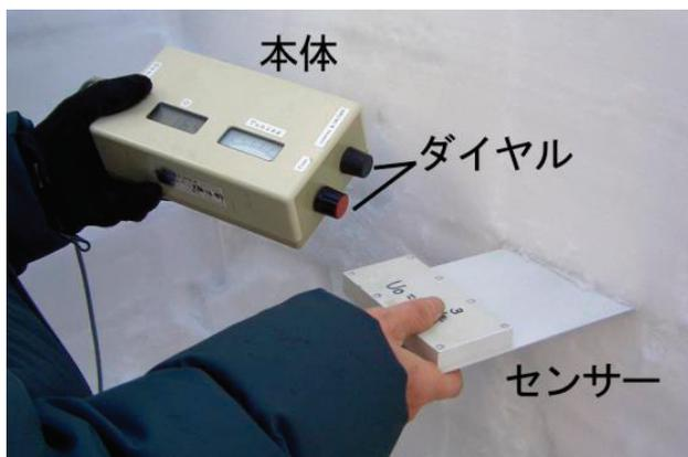
Photo 6. Denoth 式含水率計を用いた含水率の測定 (竹内ら 2009)
