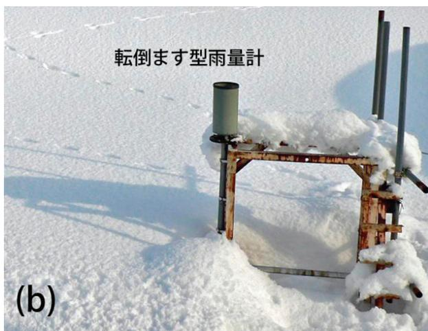
Photo 1. 十日町試験地の気象観測の様子 (a) 気温計 (通風筒) と溢水式降水量計 (風除けとヒーター付) (b) 転倒ます型雨量計 (ヒーター付)
