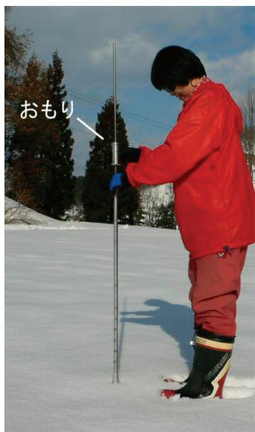
Photo 9. ラムゾンデを用いたラム硬度の測定
