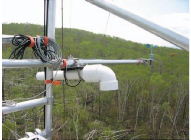
Photo 5. 通風筒付き温湿度計 HMP-45D (Vaisala)
