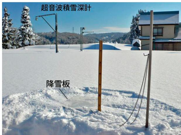
Photo 2. 降雪板 (雪板) と超音波積雪深計
