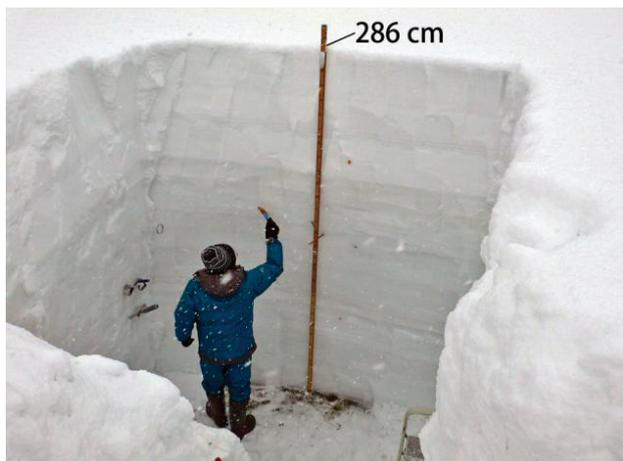
Photo 4. 積雪断面観測 撮影日 2013 年 2 月 25 日 積雪深 286 cm
