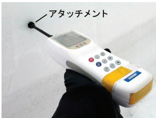
Photo 8. プッシュゲージを用いた硬度の測定 (竹内ら 2009)
