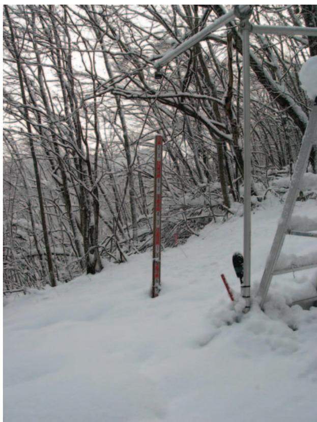
Photo 2. 露場に設置した雪尺と超音波積雪深計
