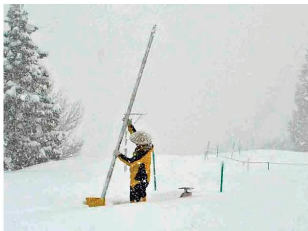
Photo 3. 神室型スノーサンプラーを用いた積雪水量の測定
