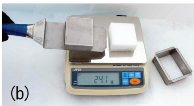
Photo 5. 密度の測定 (a) 密度サンプラー (b) 採取した 100 cm<sup>3</sup> の雪の質量を測定 (竹内ら 2009)
