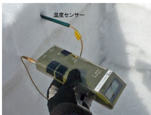
Photo 5. 雪温の測定 Measurement of snow temperature
