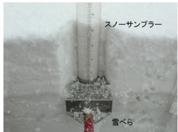
Photo 10. アクリル製の円筒形スノーサンプラーを用いた積雪水量の測定 Measurement of snow-water equivalent using the acrylic cylindrical snow sampler
