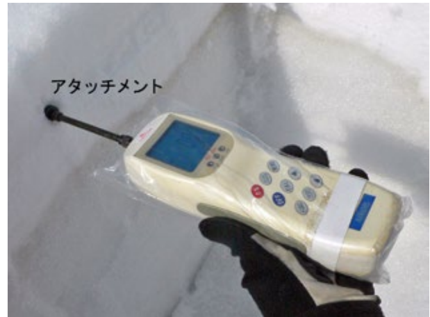
Photo 9. プッシュゲージを用いた硬度の測定 Measurement of snow hardness using the push-gauge
