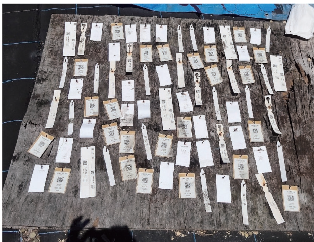
Fig. 3. 実験終了時 (3 年後) のラベルの様子 The labels at the end of the experiment (three years later).
