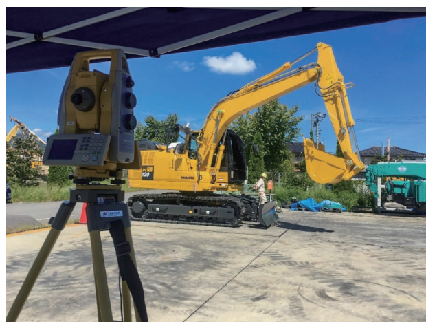
Photo 1. TS を用いた精度測定試験の様子
