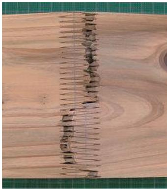
フィンガーの根元での破壊
