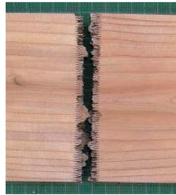
フィンガーの根元での破壊
