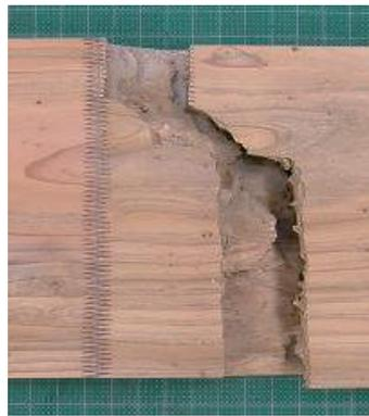
フィンガーの根元での破壊と FJ 外での木部破壊が混在した破壊
