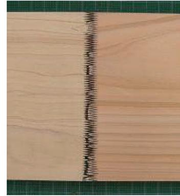
フィンガーの根元での破壊
