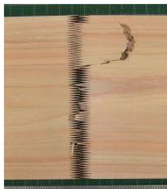
フィンガーのスカーフ面での破壊
