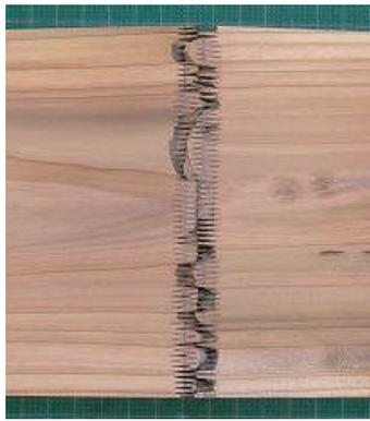
フィンガーの根元での破壊
