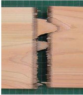
フィンガーの根元での破壊と FJ 外での木部破壊が混在した破壊
