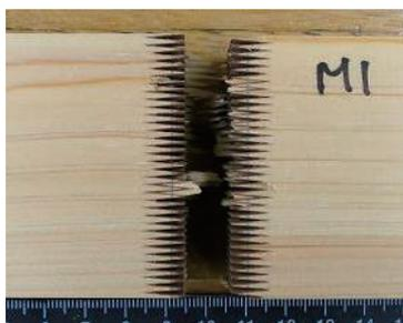
フィンガーの根元での破壊と
