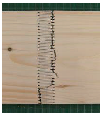
フィンガーの根元での破壊 Wood failure at the FJ roots
