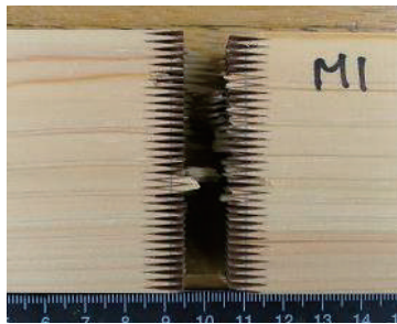
フィンガーの根元での破壊と スカーフ面での破壊が混在した破壊 Wood failure at the FJ roots and failure along the FJ profile
