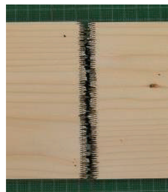
フィンガーの根元での破壊 Wood failure at the FJ roots
