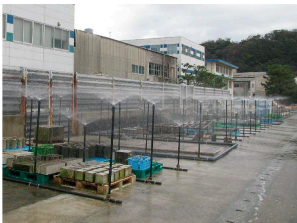
1c 飛沫帯暴露試験場
