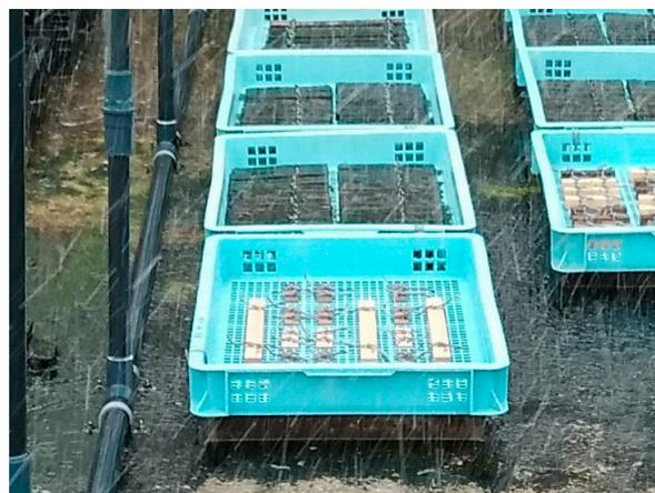
1d 飛沫帯暴露試験
