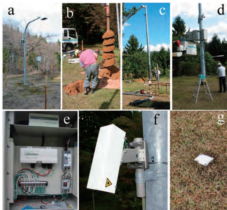
Photo 1. 新たに導入したレーザ式積雪深計
