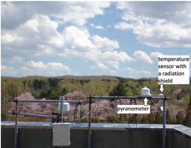
Photo 6. バックアップ用に運用している日射計とラジエーションシールドを用いた温度計
