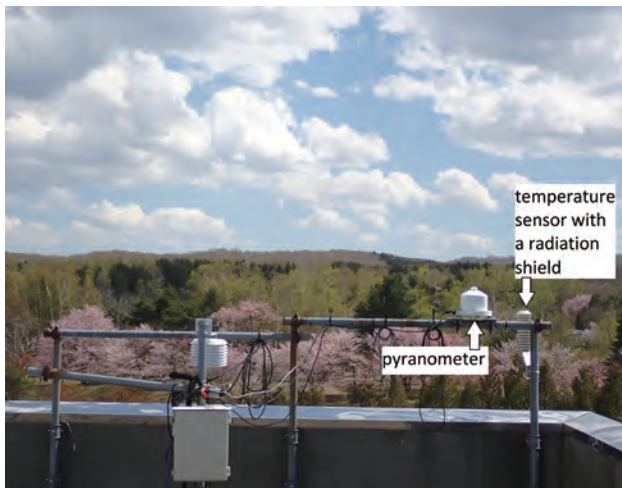
Photo 6. バックアップ用に運用している日射計とラジエーションシールドを用いた温度計 Pyranometer and temperature sensor covered with a radiation shield for data backup
