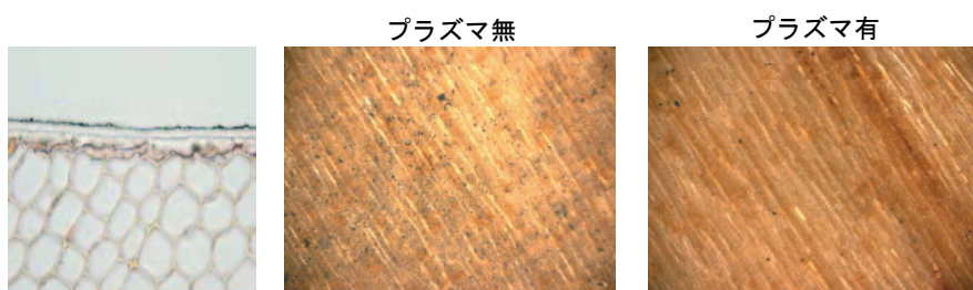
図5 スギ材塗装面 (造膜) の CB 汚染
