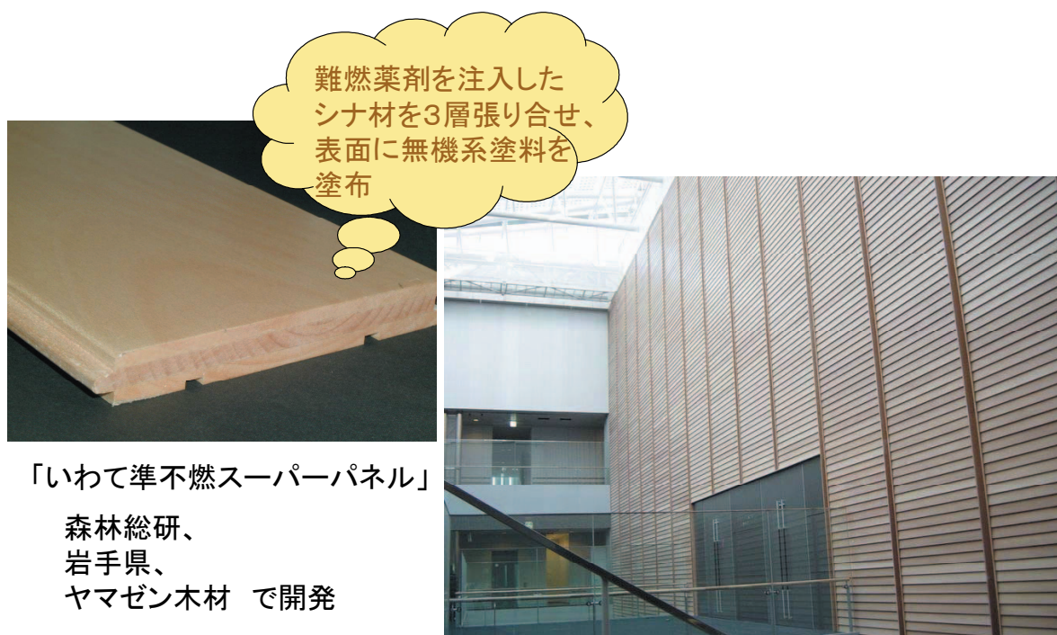
図2 開発した準不燃木材と施工例
