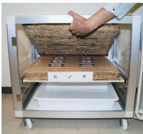
図3 テルペン類のダニ行動抑制効果の実験 ヒノキ材を原料とした量を使って、ダニの行動を観察します。
