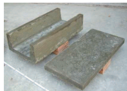
図4 熱圧爆裂ストランドを用いた製品試作
