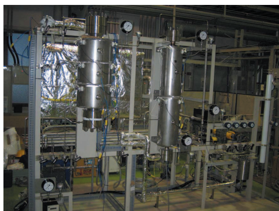
図3 ベンチプラントの反応装置
