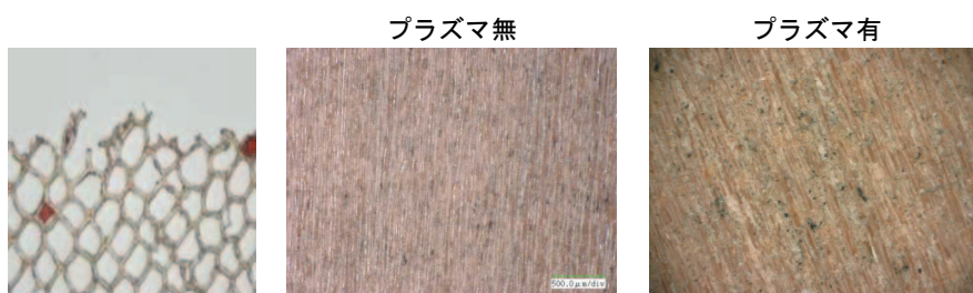
図6 スギ材無塗装面の CB 汚染
