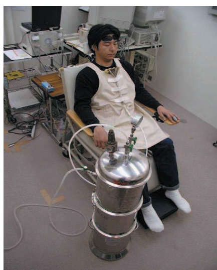
図1 テルペン類の人体への生理作用の実験 テルペン類を吸入して血圧を測定しているところです。
