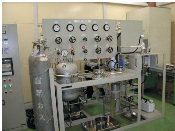
図1 半流通式反応装置（ラボスケール装置）
