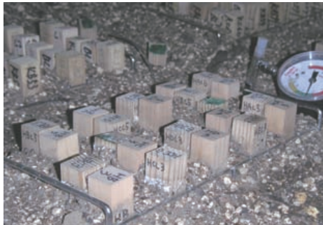
写真2 ファンガスセラー試験の様子 菌の活性が高い土壤に試験体を埋め 腐り方の早さを調べているところ
