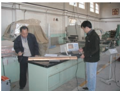
写真 1 丸太の縦振動法による測定
