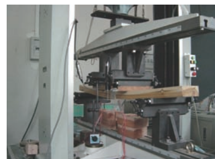
図 3 製材品の曲げ試験方法
