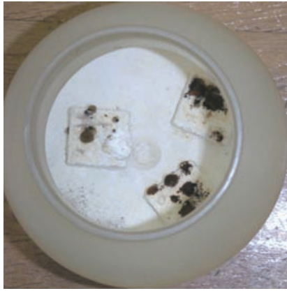
写真1 室内腐朽試験の様子 腐朽菌が試験体を覆っているところ (出っ張っている部分が試験体)
