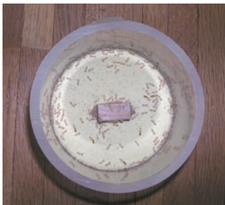
写真3 強制耐蟻性試験の様子 中央に置いた試験体にシロアリが 群がっているところ
