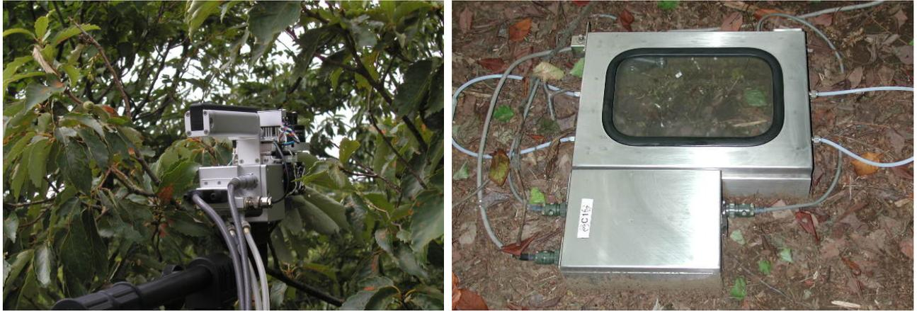
図1 個葉の光合成・呼吸特性および土壌呼吸量測定の様子（左図：自動光合成測定装置による光合成・呼吸特性の測定、右図：自動開閉型チャンバーを用いた土壌呼吸量連続測定、いずれも埼玉県川越試験地）
