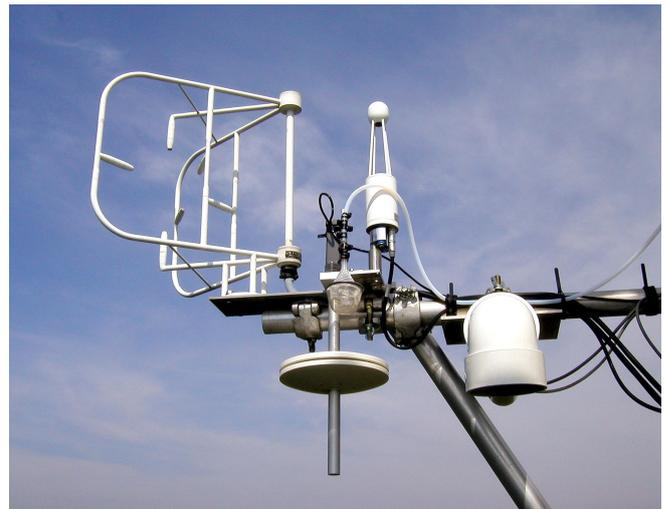
図2 微気象学的手法による森林群落の純生産量の測定に使用する測器群（フラックス観測タワーに設置した超音波風速温度計、赤外線CO2分析計、温度・湿度計、気圧計など）
