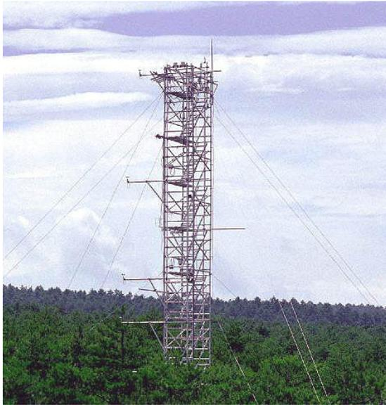
図1 森林群落の純生産量を測定するために設置したフラックス観測タワー（山梨県富士吉田試験地、アカマツ林）
