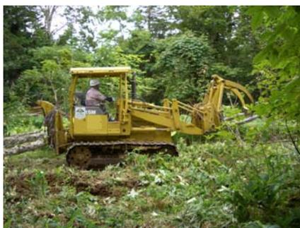
できるだけD3クラスなどの小形のブルドーザを使用します。
