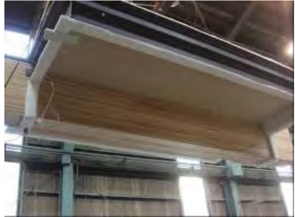
写真6 梁・天井床接合部試験体 (加熱前)
