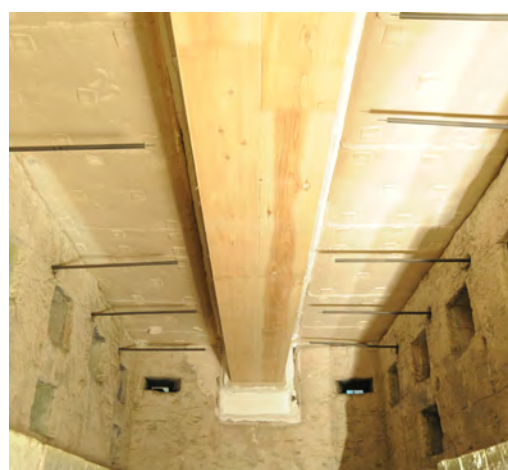
写真4 試験体設置状況－水平炉内部
