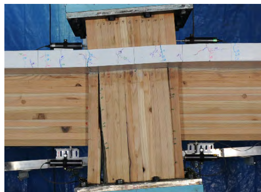
写真 4 (b) 最終破壊状況 (WCSJ-CD)
