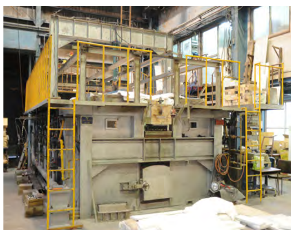
写真3 試験体設置状況－水平炉外観
