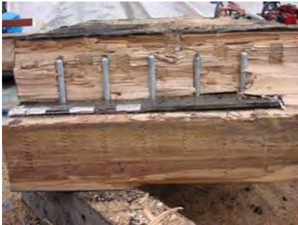
写真7 加熱後の状況 (ドリフトピン接合部)
