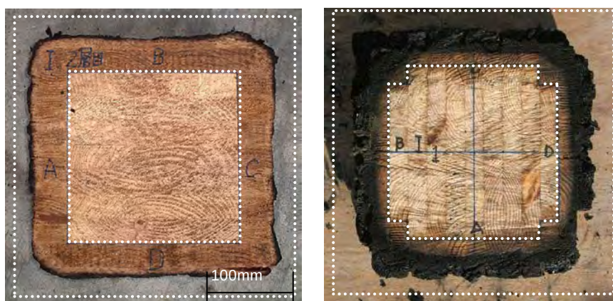
写真2 1時間耐火試験の試験後断面 (左：スギ試験体、右：カラマツ試験体)
