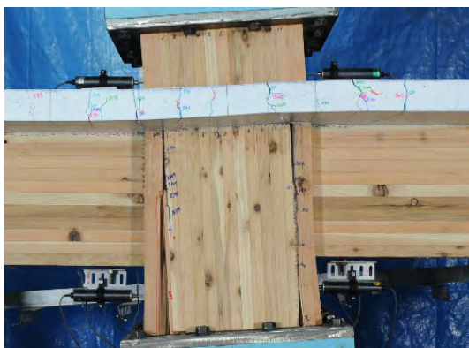
写真 4 (a) 最終破壊状況 (WCSJ-CC)
