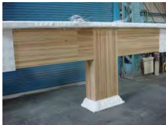
写真4 柱・梁接合部試験体 (ドリフトピン・ボルト接合)
