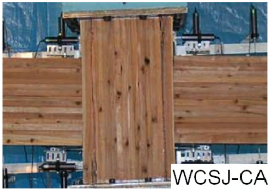
写真 3 (a) 最終破壊状況 (WCSJ-CA)
