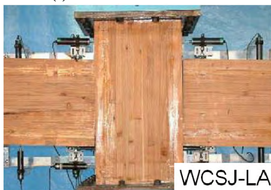
写真 2(c) 最大荷重時の状況 (WCSJ-LA)
