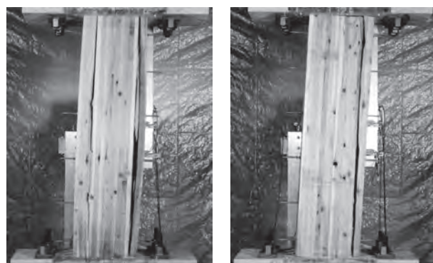
写真 2 終局時の破壊状況
