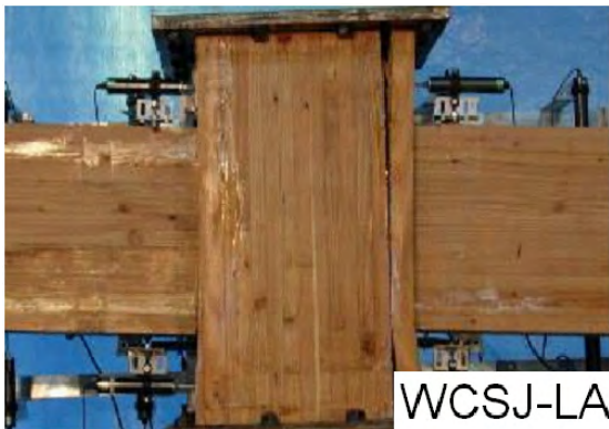
写真 3 (c) 最終破壊状況 (WCSJ-LA)
