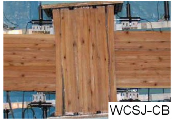
写真 3 (b) 最終破壊状況 (WCSJ-CB)
