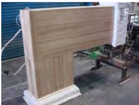
写真3 柱・梁接合部試験体 (ドリフトピン接合)
