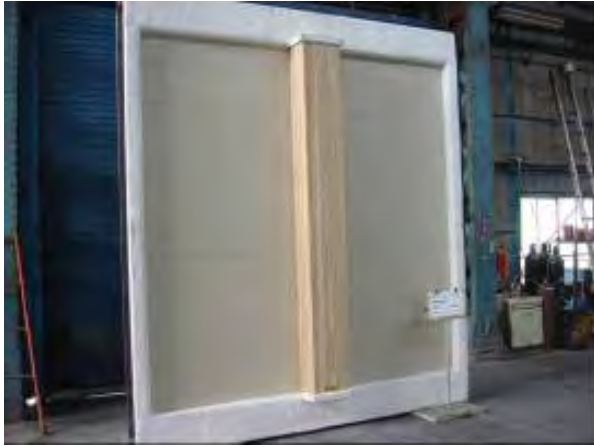
写真5 柱・壁接合部試験体 (加熱前)
