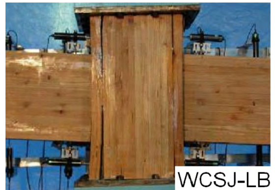
写真 3 (d) 最終破壊状況 (WCSJ-LB)
