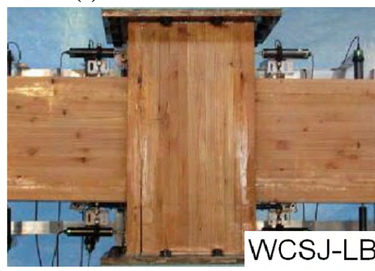
写真 2(d) 最大荷重時の状況 (WCSJ-LB)
