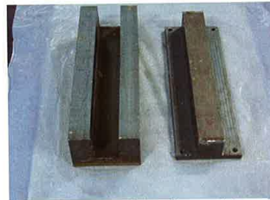
写真 1.7.1 ピン調整用の治具
