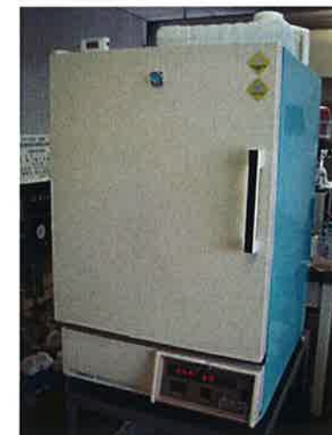
図 2.5.1 竹建築ボードの吸放湿試験
