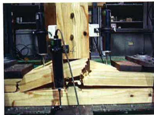
写真1.7.4 長方形プレート2枚を使用した接合部の破壊の様子
