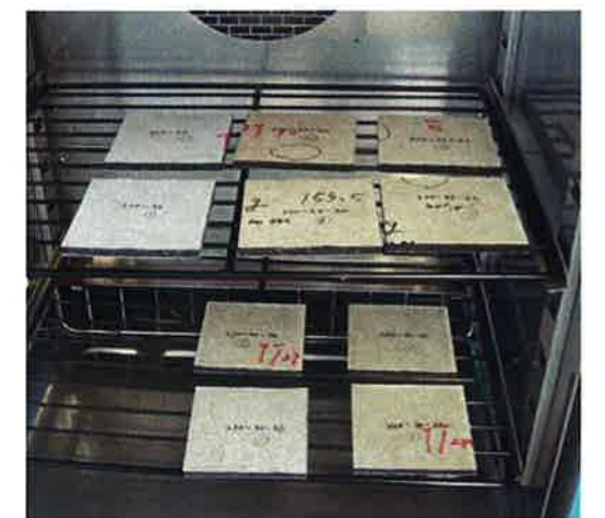
図 2.5.1 竹建築ボードの吸放湿試験
