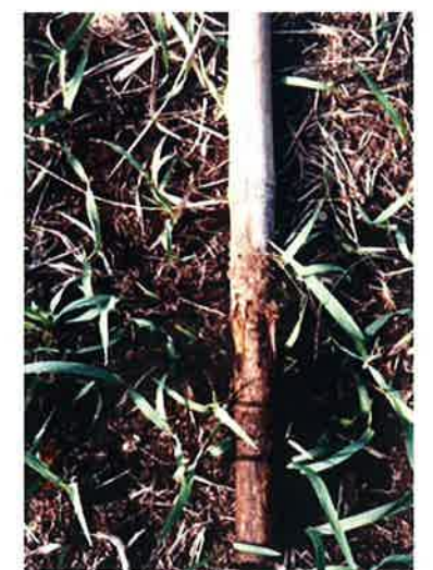
写真 1.1.4 ステークテスト における腐朽
