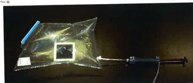
図 2.5.2 テドラーバッグ法による竹建築ボードのガス吸着試験
