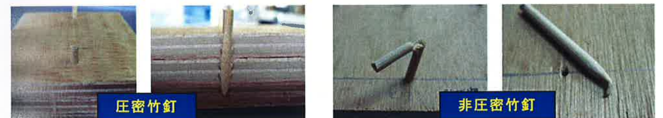
写真 1.8.5 打ち込み実験の様子
