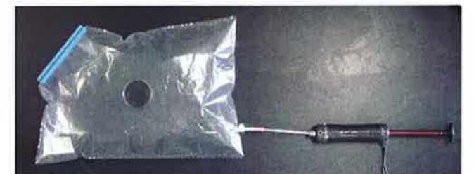
図 2.4.2 テドラーバッグ法による竹炭のガス吸着試験
