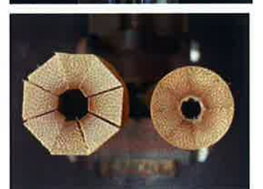
写真1.8.2 絞り加工による圧密化の様子
