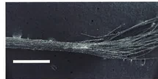
写真2.7.3 繊維状ElementのSEM像(スケールバー:500μm)
