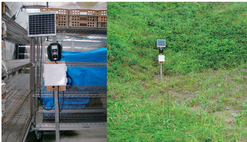
赤外線センサーにより自動写真撮影が可能な監視カメラ及び設置イメージ
