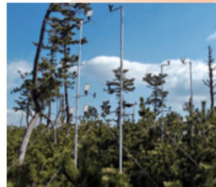
図1 風速と空中塩分量の現地測定状況
