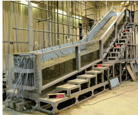
図 15 集中豪雨による斜面の崩壊を再現する大型の斜面模型実験。毎時 100mm の豪雨では 2,891 秒で崩壊が発生した。
