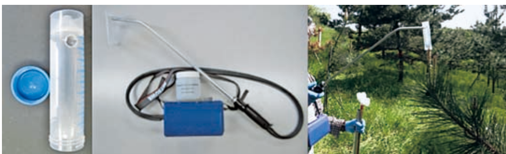
図19. 遠沈管（左）を取りつけた花粉交配器（中央）を用いた採種園における SMP（右）
