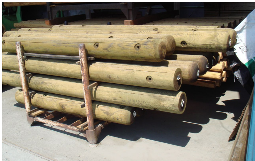
写真 -1.5.3 ボルト穴などへの加工を施した後に加圧式保存処理で薬剤を注入した例
