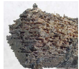
写真-2.3.7 キクイムシの食害を受けた 4cm 角スギ材の外観
