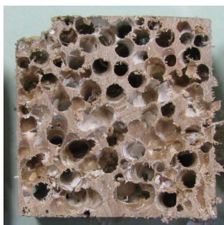
写真-2.3.5 フナクイムシの食害を受けた4cm角ブナ材の断面
