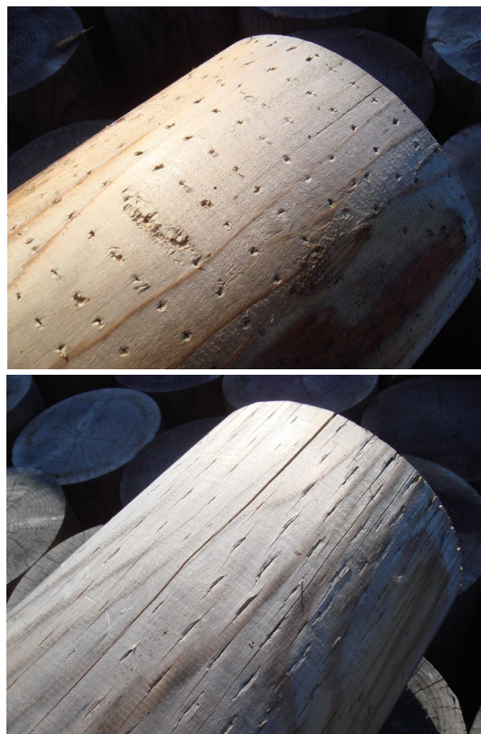
写真-1.5.5 インサイジングによって表面を刺傷した円柱加工材 上：針式インサイジング 下：ナイフ式インサイジング
