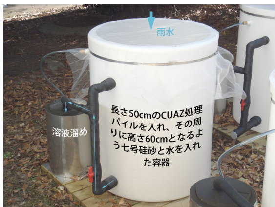
写真 -1.5.9 市販パイルを用いた溶脱実験の様子 直径 14cm、長さ 50cm の保存処理パイルを使用 パイルの周囲及び上部は東北珪砂 7 号で覆った 井戸水及び雨水の浸入によって容器から 溢れ出てくる水を回収し、 そこに含まれる薬剤量を測定した。
