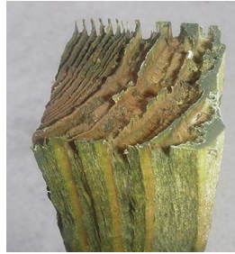
写真-2.3.9 ウェザリング によって目やせが生 じたスギ材の木口面
