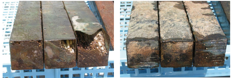
写真-2.4.6 海中に8年間暴露した無処理のスギ材 寸法：4cm × 4cm × 40cm、左：エポキシ樹脂を塗装した試験体、右：炭素繊維シートをエポキシ樹脂で接着した試験体（海水中設置8年後）
