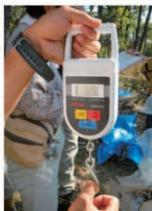
(5) Balanza de muelle electrónica (50 kg)
