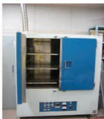
(1) Horno de secado de convección forzada
