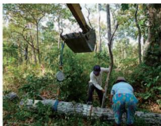
Fotografía 14: Pesaje en fresco de troncos usando una excavadora
