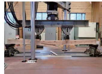
写真3 曲げ試験の実施状況
