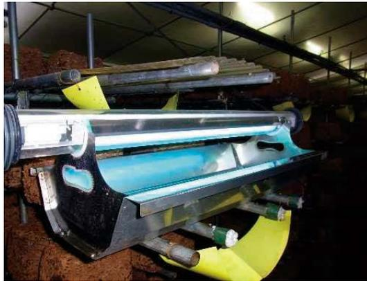
写真2 捕虫蛍光管と水盤による殺虫器
