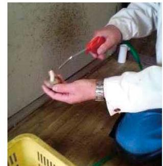
写真22 圧縮空気による異物の除去
