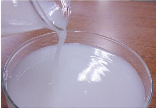
図1 スギソーダAQパルプから酵素・湿式粉碎で製造したCNF
