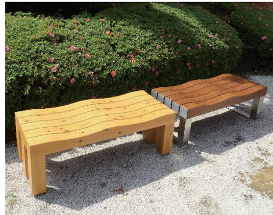
図3 CNF配合塗料を下塗りに用いて塗装した室内用(左)及び屋外用(右)ベンチ
