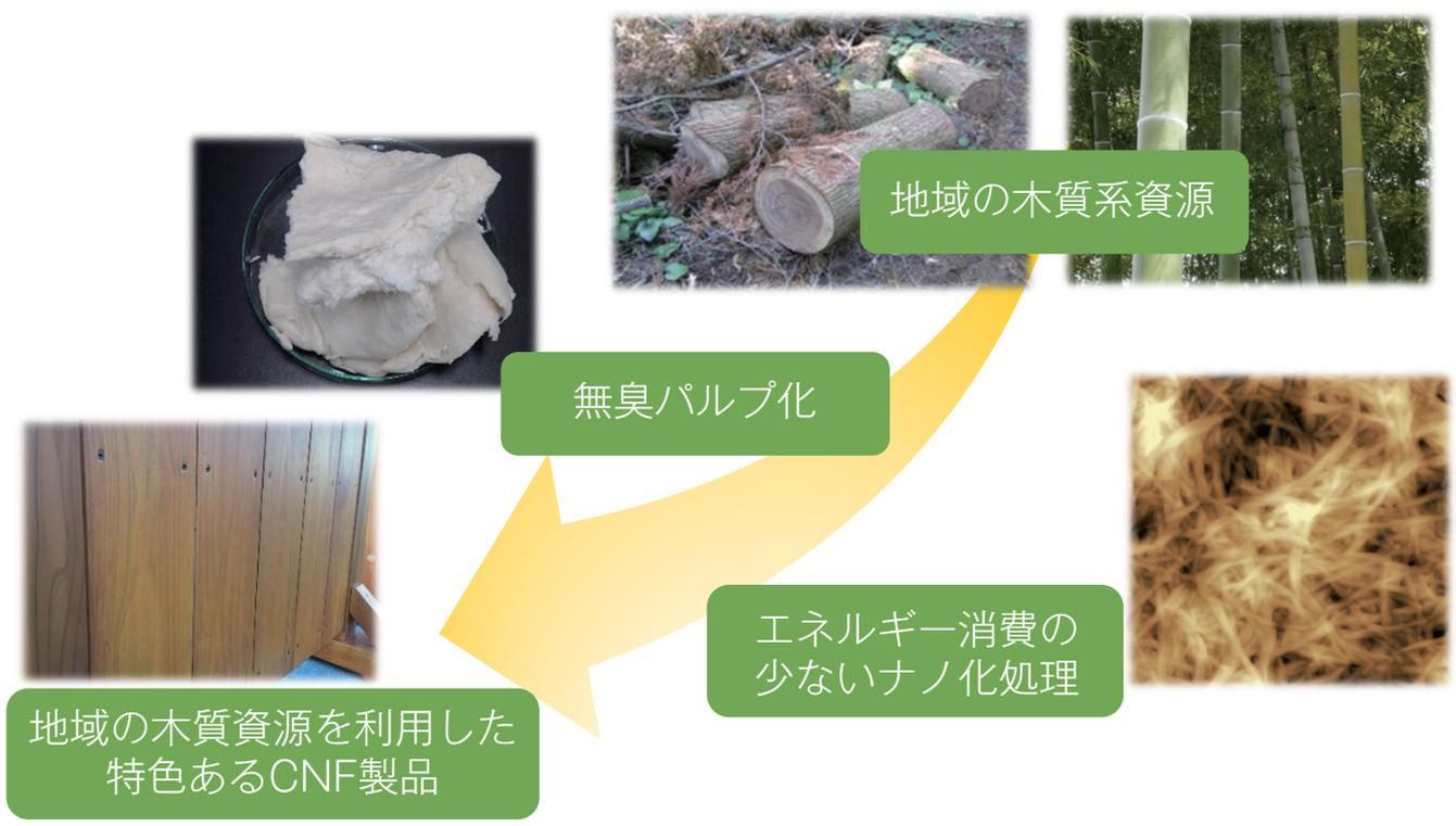
図1 中山間地域でのCNF一貫製造
