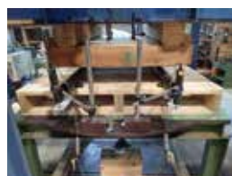
下面デッキボード試験
