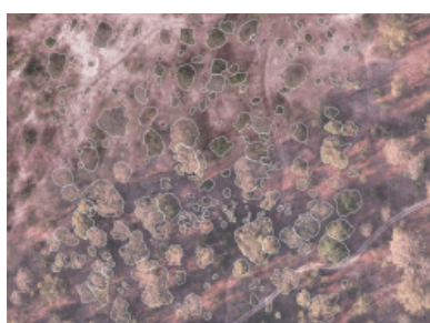
Figure T17-2 Canopées en polygone extraites de photos aériennes numériques par mesure stéréoscopique
