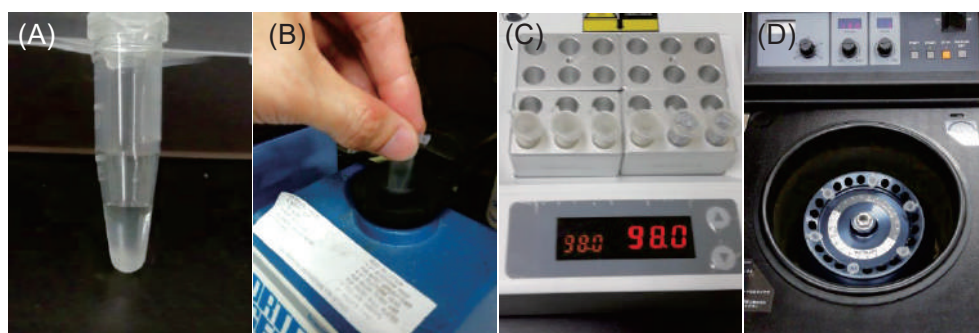
図 4-2 溶液への懸濁(A)、攪拌(B)、加熱(C)、遠心分離(D)による DNA の抽出
