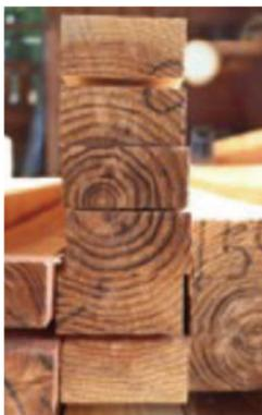
図 40. 成長が早いスギから得られた桝組壁工法用製材
