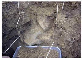
11) ブロック内の土壌は全量採取。石礫が大きい場合には隙間の土壌を集める。
