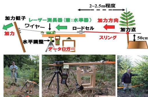
図88. 引き倒し試験の概要と実施状況
