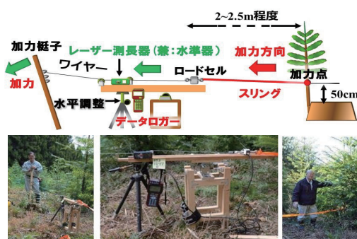
図88. 引き倒し試験の概要と実施状況
