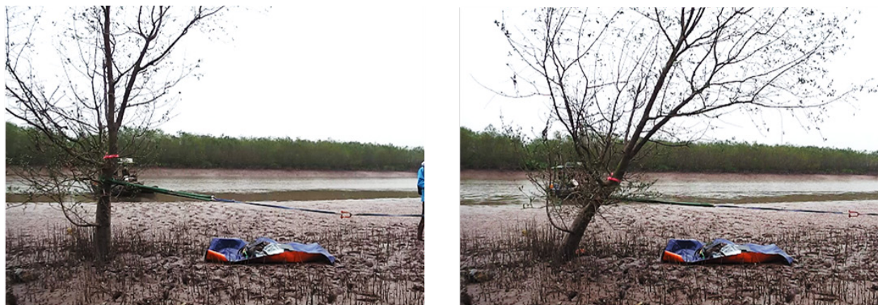
図 T10-2 S. caseolaris の引き倒し試験の様子
