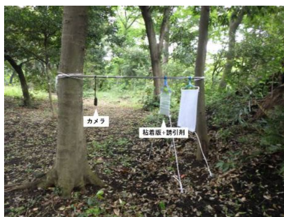
写真2 定点カメラと粘着板を組み合わせた定期的な回収を必要としない新しいトラップ 粘着版を定期的に撮影して、カシノナガキクイムシが貼り付いた日を写真から特定する。
