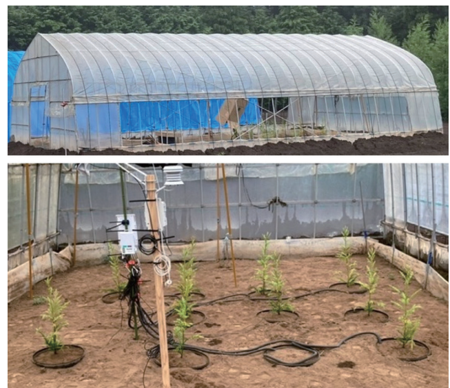
図5 屋外で降雨遮断実験を行ったビニールハウス（上）とハウス内に植栽したスギ苗木（下）
