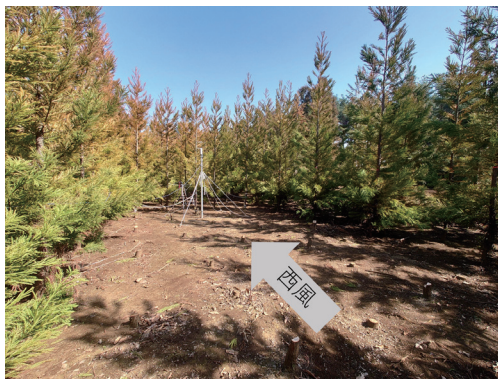
図5 伐採試験プロット内の写真。林内ギャップ西端から東方向に見た様子。中央に写っているポール先端に風速計を取り付け、ギャップ内の風速を測定しました。
