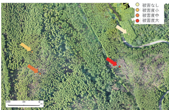
図 3 UAV 画像を用いた千葉県君津市有林周辺のオルソ画像 図 2 で被害大（赤）と判定された領域は強風でほとんどすべての立木が幹折れ、根返りし壊滅的な被害を受けていた。被害度中は半数程度が被害木の林分で、被害度小は、所々に被害木が見られる状態であったことがわかります。
