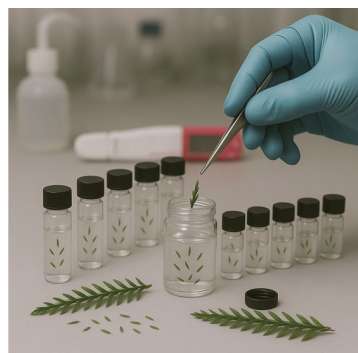
図1 スギの葉の電解質漏出率測定 のイメージ 超純水の入ったバイアル瓶にサンプルを投入します。奥に置かれているのが電気伝導率計です。
