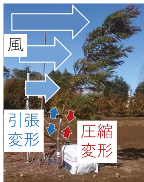
図1 立木に働く風荷重と幹に生じる変形
