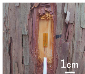
図2 木の幹に貼られたひずみゲージ 樹皮を剥いで材に接着します。
