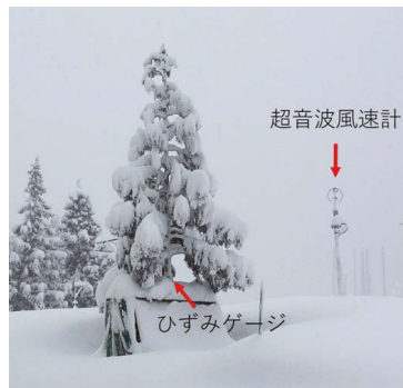
図1 スギ樹冠に生じる風荷重と着雪量の測定装置
