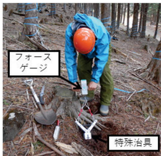
図17 根の引抜試験の様子
