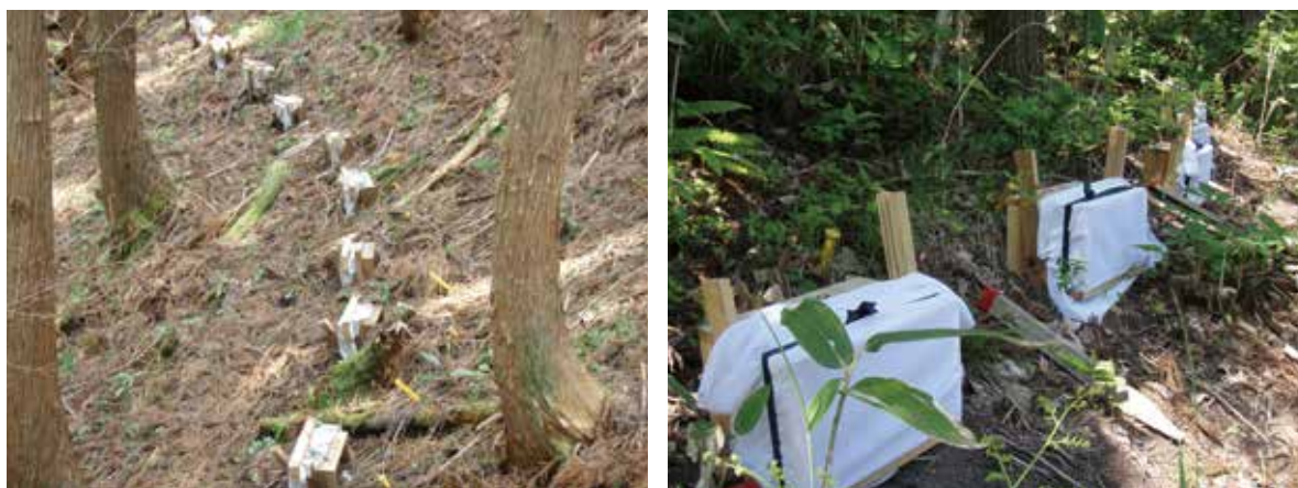
図 26. 林内に設置された土砂受け箱による土砂移動量の測定の様子
