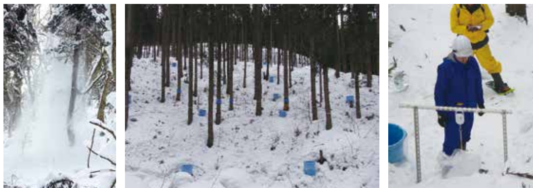
図 37. 林内において樹冠に貯留されていた雪が落ちる瞬間の様子（左）、大型貯留式雨雪量計を使用して冬期の樹冠通過降水量を測定している様子（中央・右）
